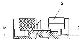
**Gerade Verschraubung mit Schraubkupplung M16**
