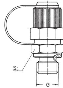
Einschraubgewinde: Whitworth-Gewinde, zylindrisch - Einschraubzapfen mit Dichtung
