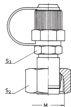
**Hochdruck-Meßschläuche DN 2 für Schraubkupplung M16**
